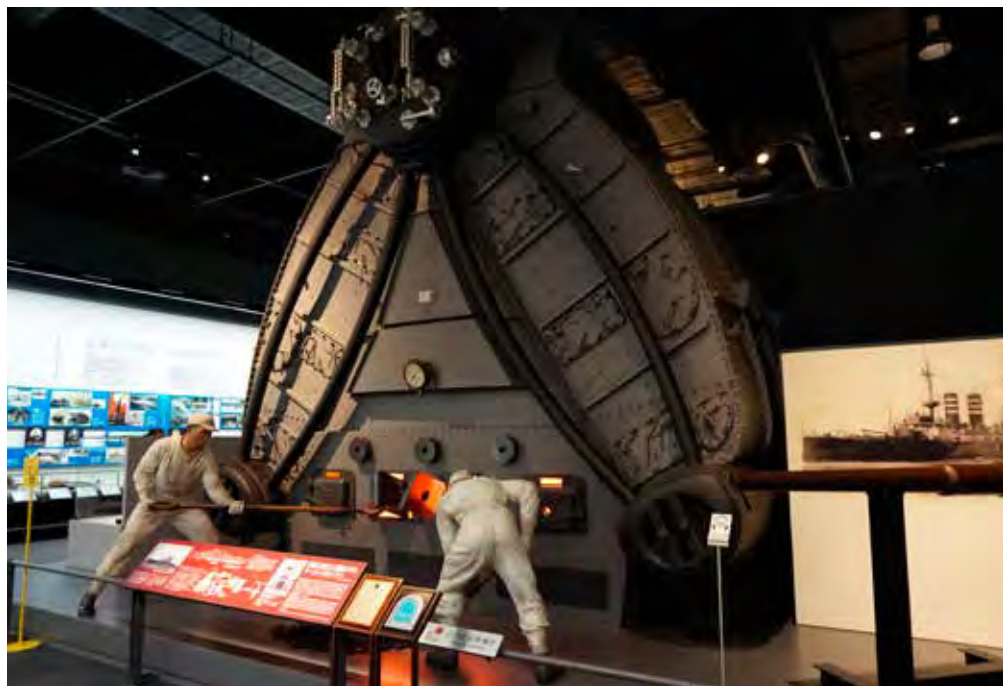
戦艦「金剛」に搭載されたヤーロー式ボイラー
